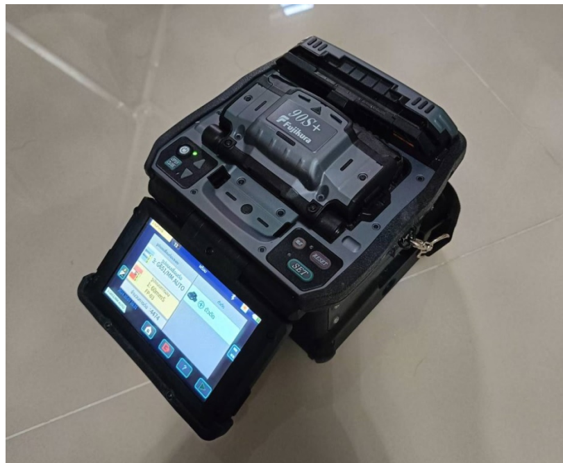
รูปที่ 6.13 Fiber Optic Fusion Splice ยี่ห้อ Fujikura รุ่น 90s+
