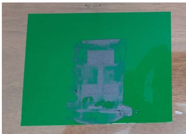
รูปที่ 5.19 การปาดสกรีนกาวกราฟิต์ลงบนแบบพิมพ์สติกเกอร์
