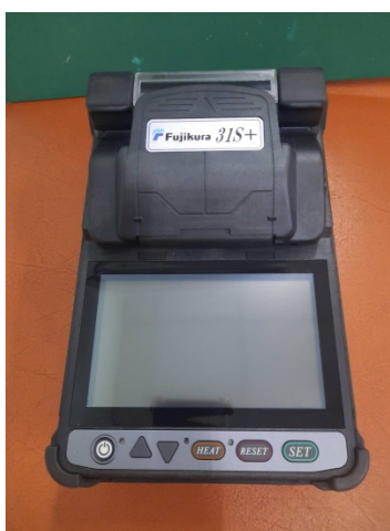
รูปที่ 6.12 Fiber Optic Fusion Splice
